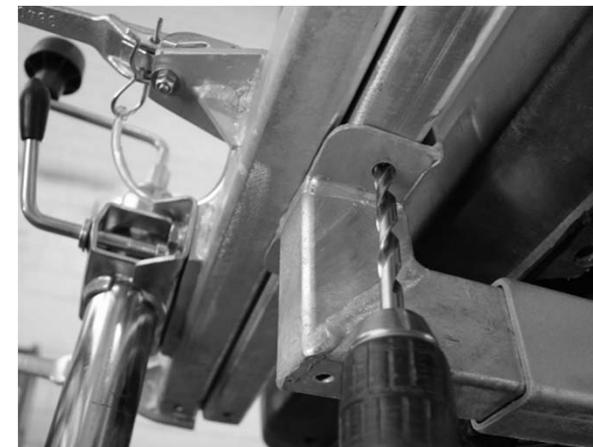
Träger und Grundhalter miteinander verbohren von Oben und Unten und anschließend verschrauben.
