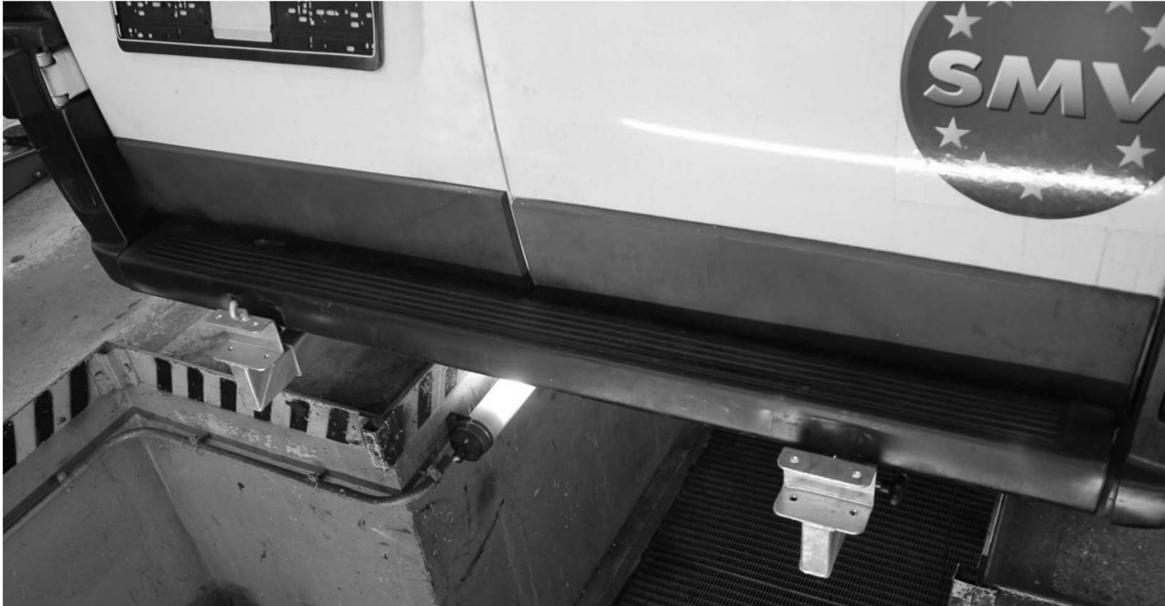
**Grundhalter einschieben in die SBA. Bohrung für den Abstecksplint wird nach Montage und ausrichten des Trägers gemacht.**
